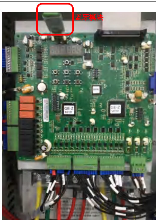
图 6.2-5 主控板及蓝牙模块
